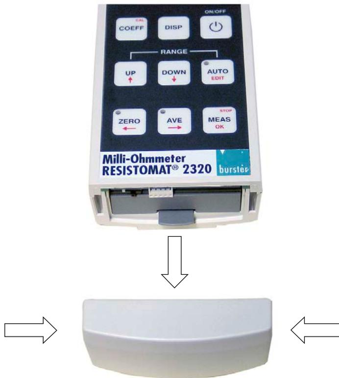
Anschließend drücken Sie die Lasche nach oben und ziehen die Batterie-kassette heraus.
