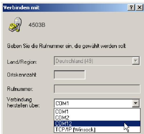
Anschliessend wird die Verbindung mit der RS-232C- oder USB-Schnittstelle definiert.
