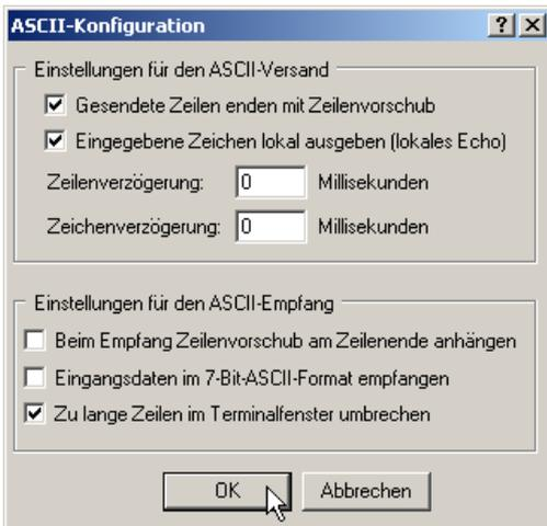
Durch Betätigen der Schaltfläche **"ASCII-Konfiguration"** öffnet sich das Fenster zur Definition der gesendeten und empfangenen ASCII-Zeichen. Folgende Einstellungen sollten getätigt werden:
