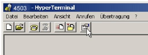
Mit dem "Eigenschaften"-Symbol
