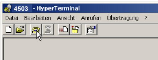
Die Verbindung zum Typ 4503B... kann nun etabliert werden, indem das **"Anrufen"**-Symbol
