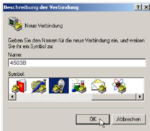
HyperTerminal® schlägt eine neue Verbindung vor. Zur Identifikation der Verbindung ist der Name zu definieren, z.B. "4503B". Auf dem Desktop kann später die HyperTerminal®-Einstellung gespeichert werden, dazu ist hierbei ein beliebiges Symbol auszuwählen.
