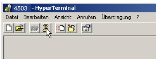
Die Verbindung zwischen HyperTerminal und Typ 4503B... wird durch Betätigen des "Auflegen"-Symbols
