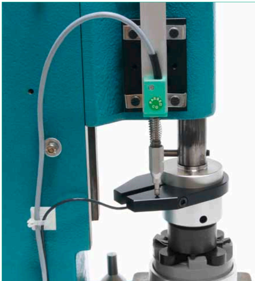
Bild 1.6: Wegmesssystem (WMS) in der unteren Position
