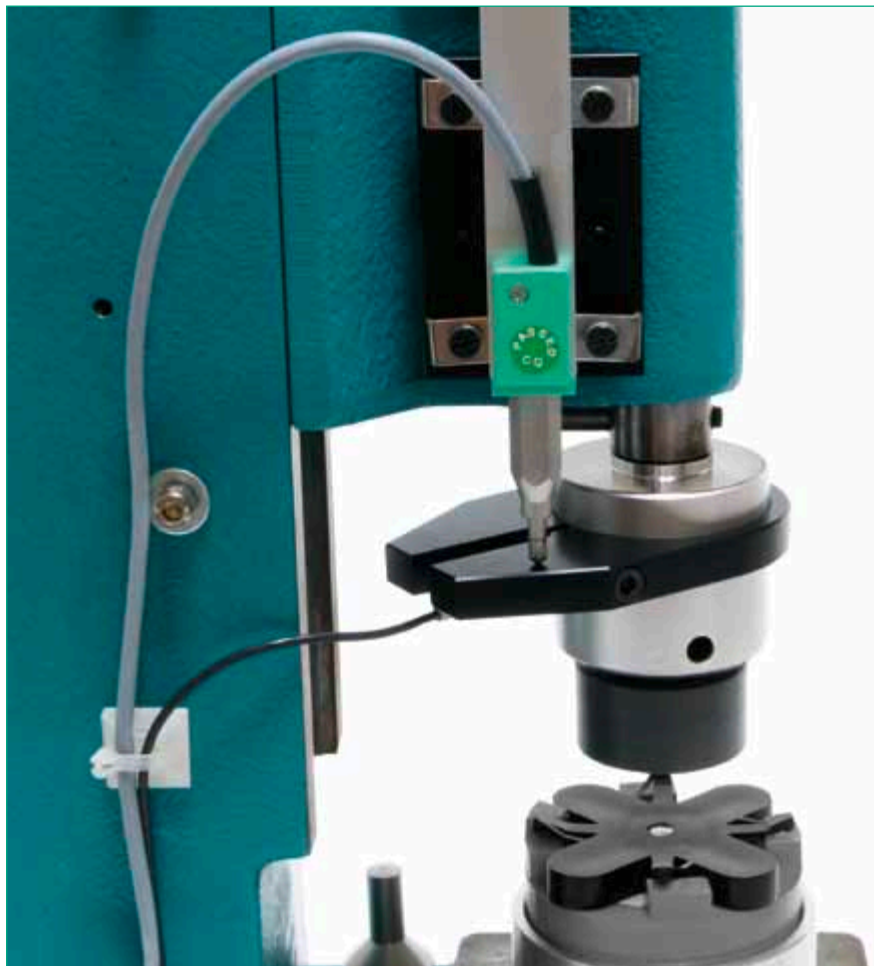
Bild 1.5: Wegmesssystem (WMS) in der oberen Position
