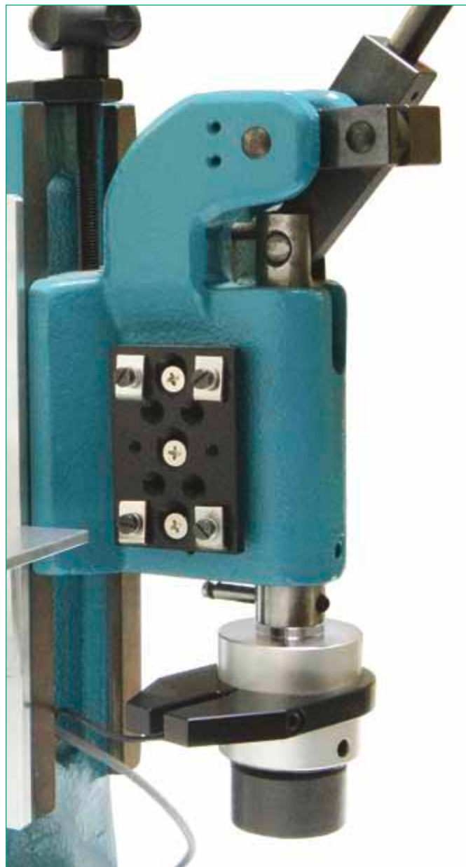
Bild 1.4: Wegmesssystem (WMS) an Presse
