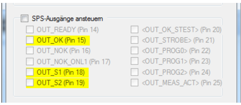
Abbildung 70: Numerischer Einrichtbetrieb – SPS-Signale
