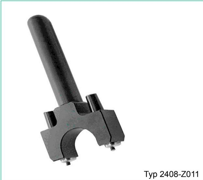
Die Elektrode Typ 2408-Z011 ist für die Messung des Oberflächenwiderstandes gemäß DIN 65181 geeignet. Der Abstand zwischen den beiden Elektroden beträgt 50 mm. Für einen guten Oberflächenkontakt sind die Elektroden aus Leitgummi gefertigt.
