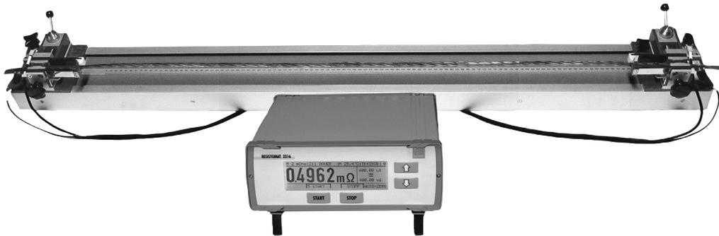
Einsspannvorrichtung Typ 2381 für Kabel mit dem Querschnitt von 0,1 mm<sup>2</sup>... 100 mm<sup>2</sup>.
