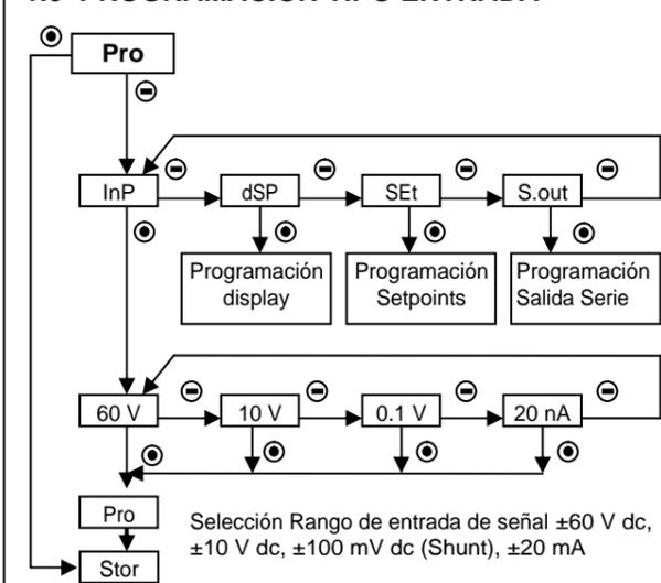
Método teach: Este sistema permite, en InP 1 e InP 2 visualizar el valor real de señal eléctrica generada por el sensor en una determinada condición y validarla mediante pulsación de la tecla  $\odot$ .
