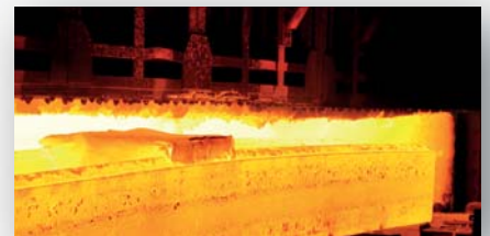
Die verwendeten Materialien und der sehr robuste Aufbau erlauben Anwendungstemperaturen bis zu 1350°C.
