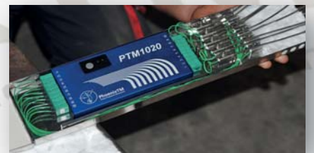
Die interne Loggeraufnahme für einfaches Handling der Messfühler schützt den Logger auch vor zu großer Hitze beim Entladen.
