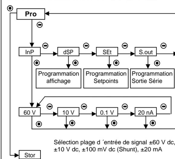
Méthode teach: Ce système permet, sur InP 1 et InP 2 de visualiser la valeur réelle de signal électrique généré par le capteur dans une condition déterminée et de la valider en appuyant sur la touche.
