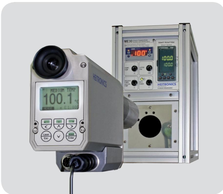
**Bild 2:** Kalibrierung des ME30 mit Transfer-Strahlungs-Thermometer (TRT)
