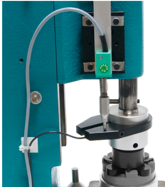
Wegmesssystem (WMS) in der unteren Position
