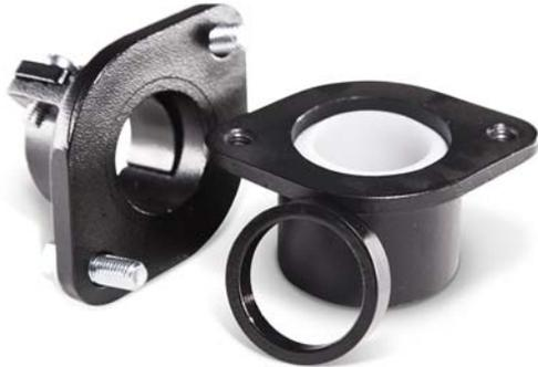
Flansche dienen der Befestigung des Thermofühlers an der Wandung der Einbaustelle. Der Gegenflansch wird mit der Wandung der Einbaustelle verschweißt und bietet somit für den Anschlagflansch einen unkomplizierten und gasdichten Montagepunkt.
