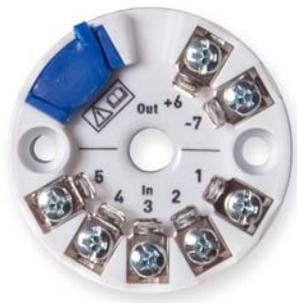
Diese universellen Temperaturtransmitter (Messumformer) werden im Anschlusskopf des Thermoelements eingebaut. Sie dienen der Umwandlung verschiedener Eingangssignale von Messstellen in Thermoelementen bzw. Widerstandsthermometern in stabile und standardisierte Signale. Je nach Ausgangssignal liegt die Stromstärke hier bei 4 - 20 mA.
