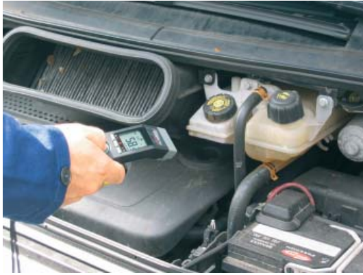
Überprüfen des Heizungssystems
