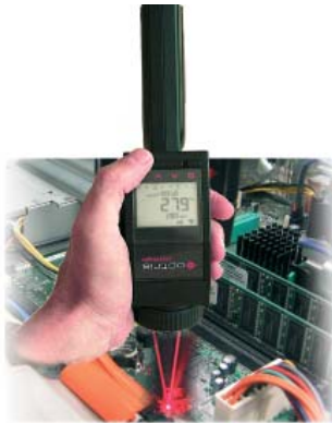
Hochgenaue Infrarottemperaturmessung mit dem optris LS LT an nur 1 mm kleinen SMD-Bauelementen beim Leiterplatten-Testlauf
