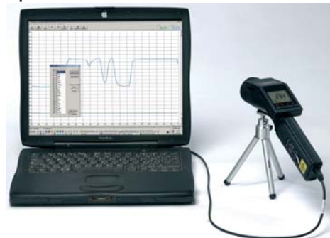
OptrisConnect Oszilloskop-Software für 20 Messwerte pro Sekunde
