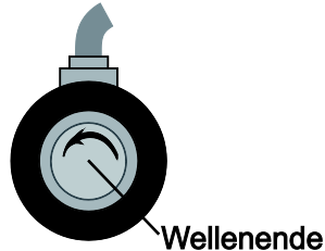
Abbildung 4: Linksdrehendes Drehmoment (Blick auf die Messseite)
