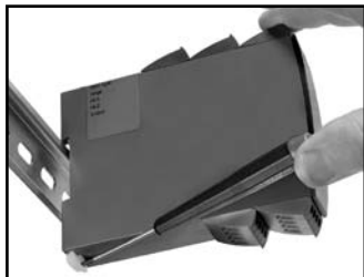
Abb. 1: Das Gerät wird von der DIN-Schiene gelöst, indem man den unteren Verschluss anhebt.
