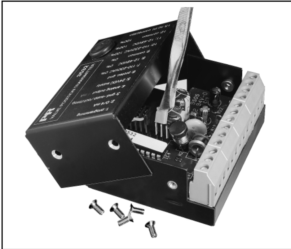
Billede 1: Adskillelse af og jumperplacering på 3532.
