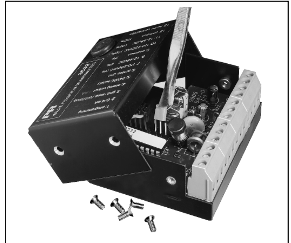
Abb. 1: Öffnen des Gerätes 3532 und Überbrückerplatzierung.
