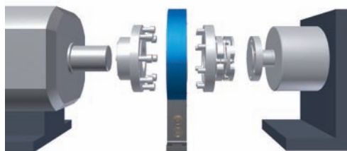
Adapterflansch + Kupplung Typ 2300A... Ausführung F: Flansch
