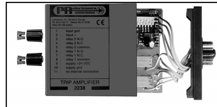
Figure 3 : Extraction de la carte à circuits imprimés pour le réglage des commutateurs et le remplacement des cavaliers.
