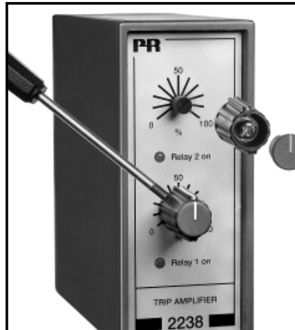
Billede 2: Afmontering af knapper.
