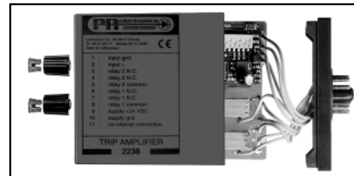
Abb. 3: Herausnehmen der Platine zur Veränderung von Schaltern und Überbrückern.
