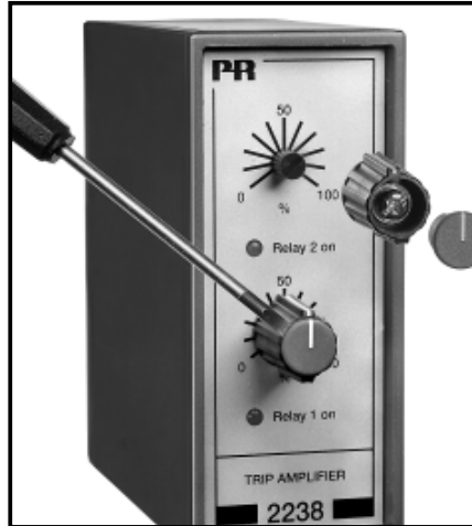
Billede 2: Afmontering af knapper.
